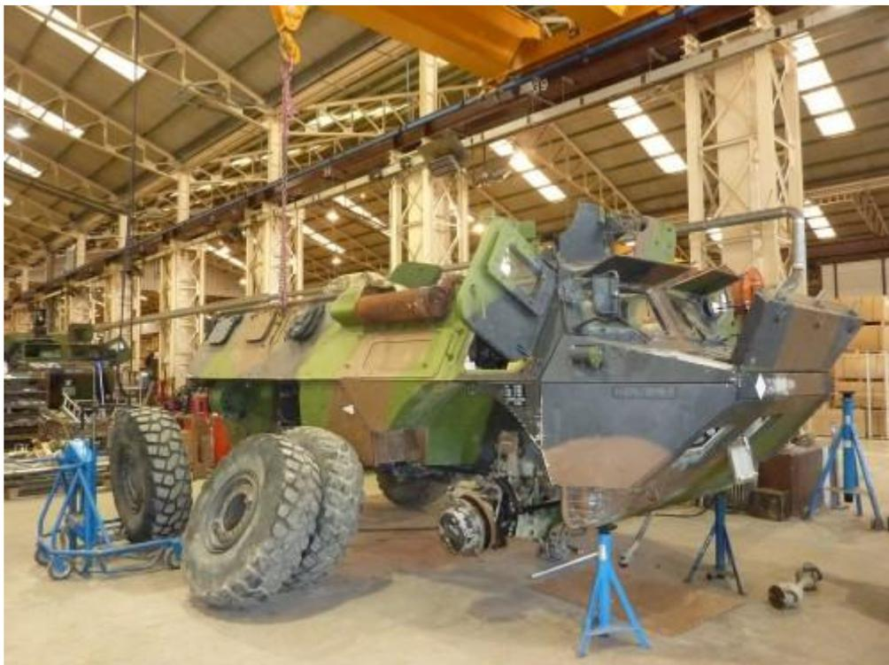
Après la phase de tri du véhicule pour en extraire les équipements légers, les outils etc, a lieu un diagnostic pour évaluer l'état du véhicule. Une quarantaine d'heures sont nécessaires aux ouvriers du 11e groupement technique pour réaliser cette phase essentielle car elle va déboucher sur la commande des pièces nécessaires aux réparations. Les stocks sont en effet très réduits.
