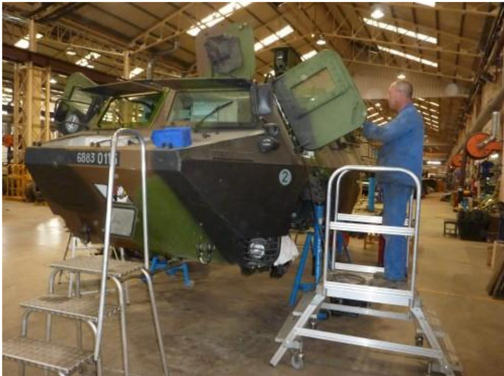
Il faut entre 250 et 400 de travail pour remettre un VAB en condition opérationnelle. Les travaux ont lieu dans l'ancienne usine construite en 1917 et dont la superficie est de 4,5 ha. 150 ouvriers y travaillent, s'occupant du diagnostic, du démontage, du prélèvement des pièces (si le véhicule est réformé), de la tôlerie, de la mécanique générale, de la peinture, de la bourrelerie.
